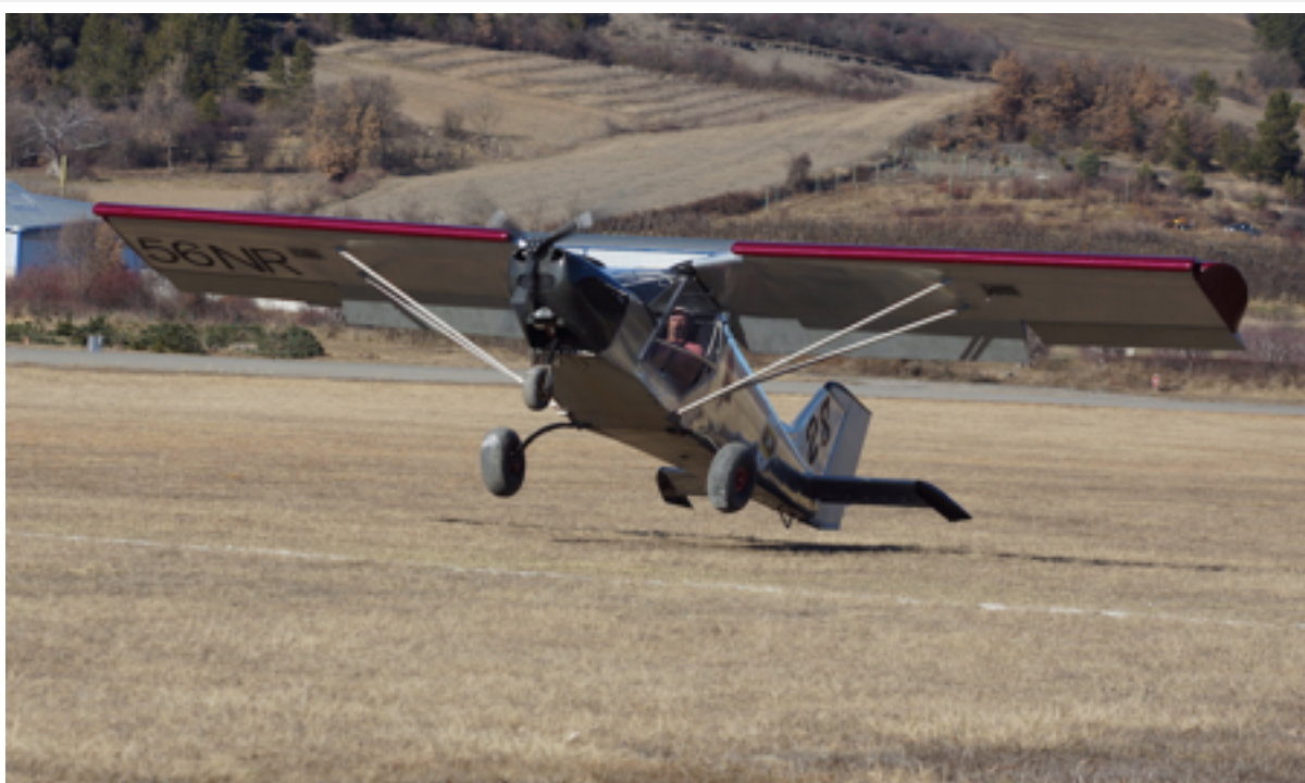
Tout au long des rotations, les lames de train des G-1 ont fait montre d'une excellente résistance. © Gabriel Gavard / Aerobuzz.fr
